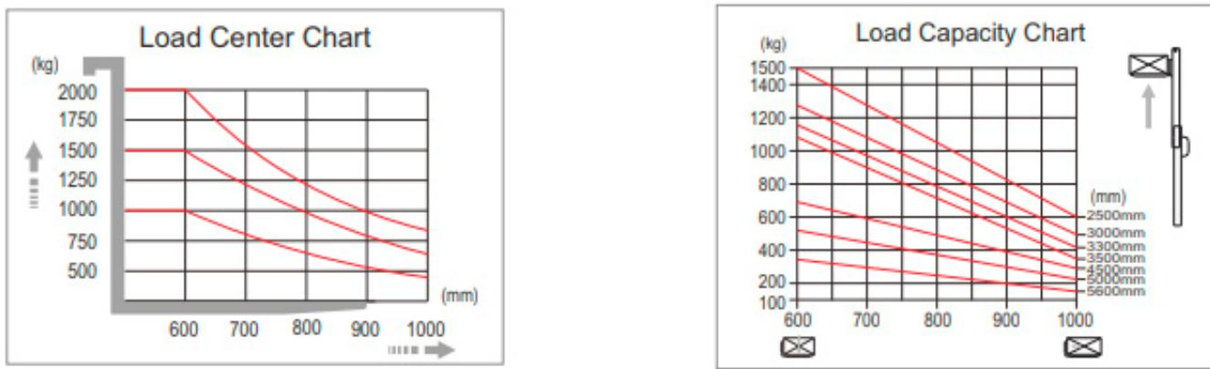
Рисунок 2. График грузоподъемности CDDK10/CDDK12/CDD15
