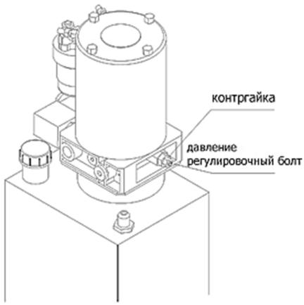
Давление предохранительных клапанов погрузчика настраивается фирмой-изготовителем. Операторы не должны регулировать давление по собственному желанию. В противном случае это приведет к опасности гидравлической системы: система безопасности погрузчика. Если давление масла не соответствует заданным значениям, пожалуйста, обратитесь к квалифицированному персоналу на предмет настройки в соответствии с методами испытаний, предусмотренных в стандартах Т3300/JB, а также следующими способами:
